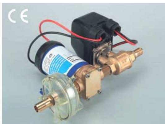
Selbstansaugende Zahnradpumpe mit Druckschalter, Filter und Rückschlagventil. Der vorgeschaltete Filter schützt vor Beschädigungen durch partikelführende Medien. Die Pumpe startet automatisch bei Druckabfall in der Steigleitung. Sie ist für den Einsatz an Zapfstellen z.B. auf Booten oder Fahrzeugen geeignet. Zur Verlängerung der Laufleistung ist der Einsatz eines Druckausgleichsbehälters empfehlenswert.
