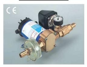
Selbstansaugende Zahnradpumpe mit Druckschalter, Filter und Rückschlagventil. Der vorgeschaltete Filter schützt vor Beschädigungen durch partikelführende Medien. Die Pumpe startet automatisch bei Druckabfall in der Steigleitung. Sie ist für den Einsatz an Zapfstellen z.B. auf Booten oder Fahrzeugen geeignet. Zur Verlängerung der Laufleistung ist der Einsatz eines Druckausgleichsbehälters empfehlenswert.
